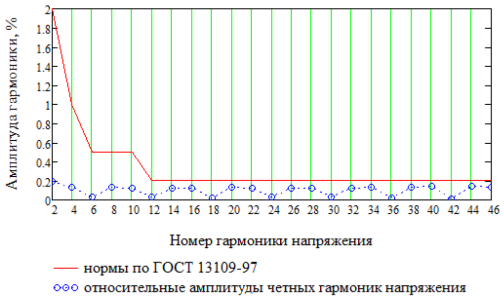
Рис.3. Относительные амплитуды гармоник фазного U_a напряжения, по отношению к первой гармонике, для ТПЧ до 4-го поколения: а) нечетные; б) кратные трем; в) четные
