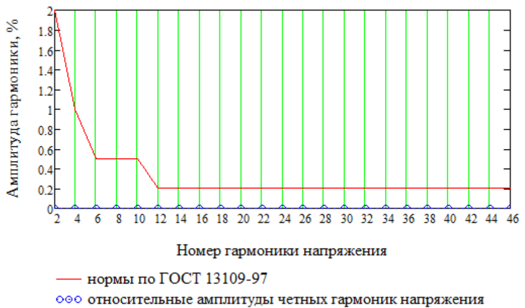
Рис.5. Относительные амплитуды гармоник фазного U_a напряжения, по отношению к первой гармонике, для ТПЧ-5 пятого поколения: а) нечетные; б) кратные трем; в) четные
